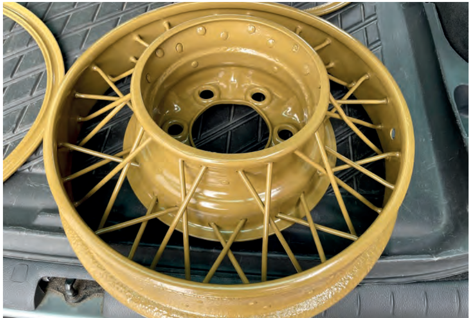
Felgene til 1930 Buick ble som nye etter pulverlakkering.
